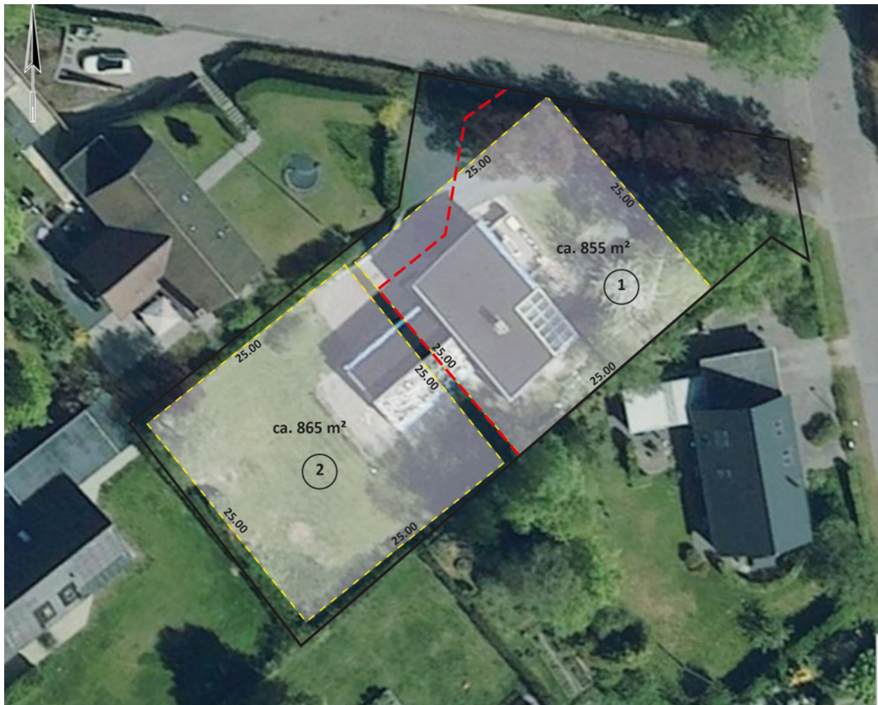
Figur 1: Udstykningsforslag viser opdeling af grunden i delnr. 1 og 2 opdelt med rød stiplede linje. Der er indlagt et 25x25 meters kvadrat for begge grunde. For delnr. 1 er overtrædelsen af 25x25 meters kvadratet ca. 38 m 2 – 3,39-3,68 meter bredt og 8,69-12,97 meter i længden.
