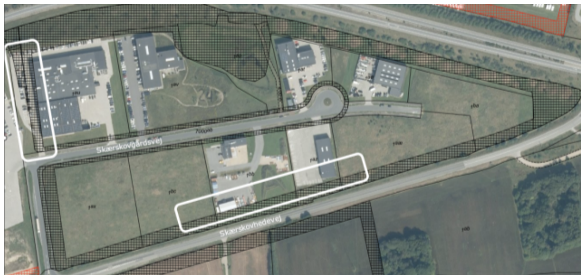
Figur 2: Luftfoto over delområde 1 i lokalplan 14-002 med lokalplanens byggelinjer og den grønne bræmme langs Skærskovhedevej (sort markering). De hvide markerede områder viser, hvordan virksomhederne har efterlevet lokalplanens bestemmelser.
