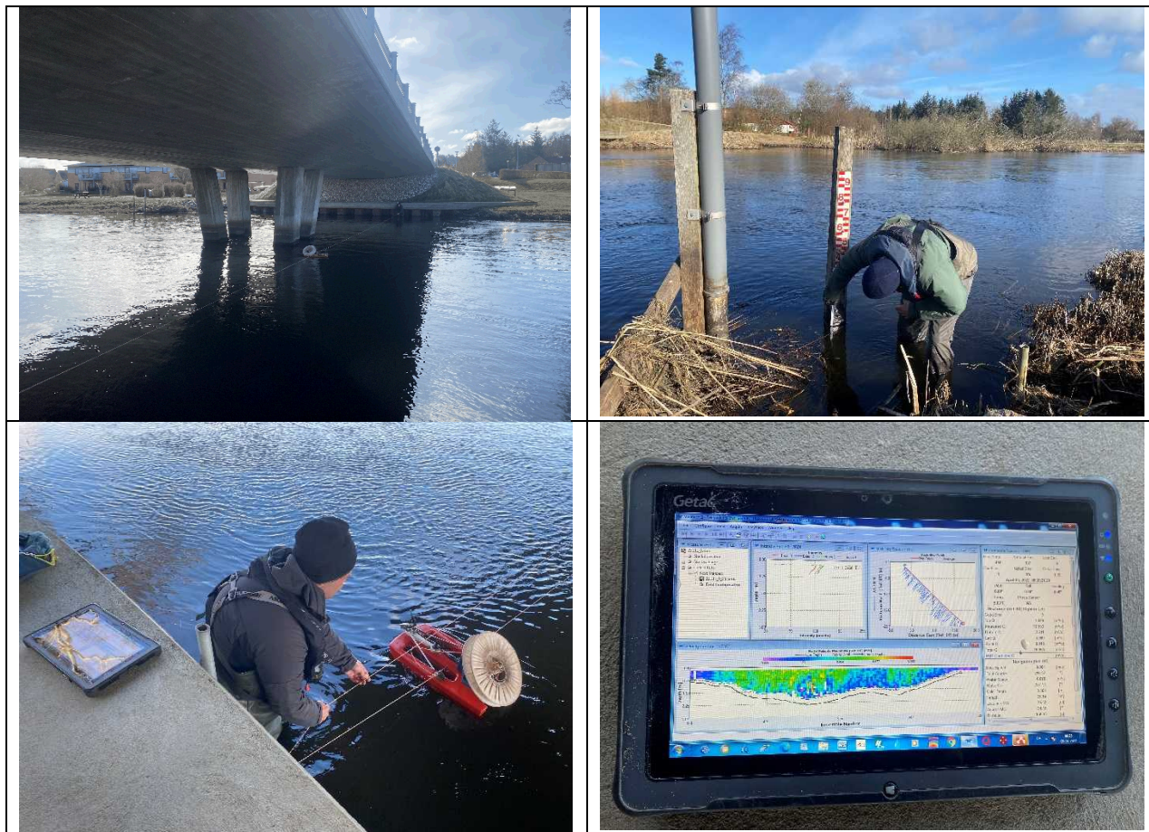
Fotos: Måling af vandføring og vandstand ved Resen Bro
