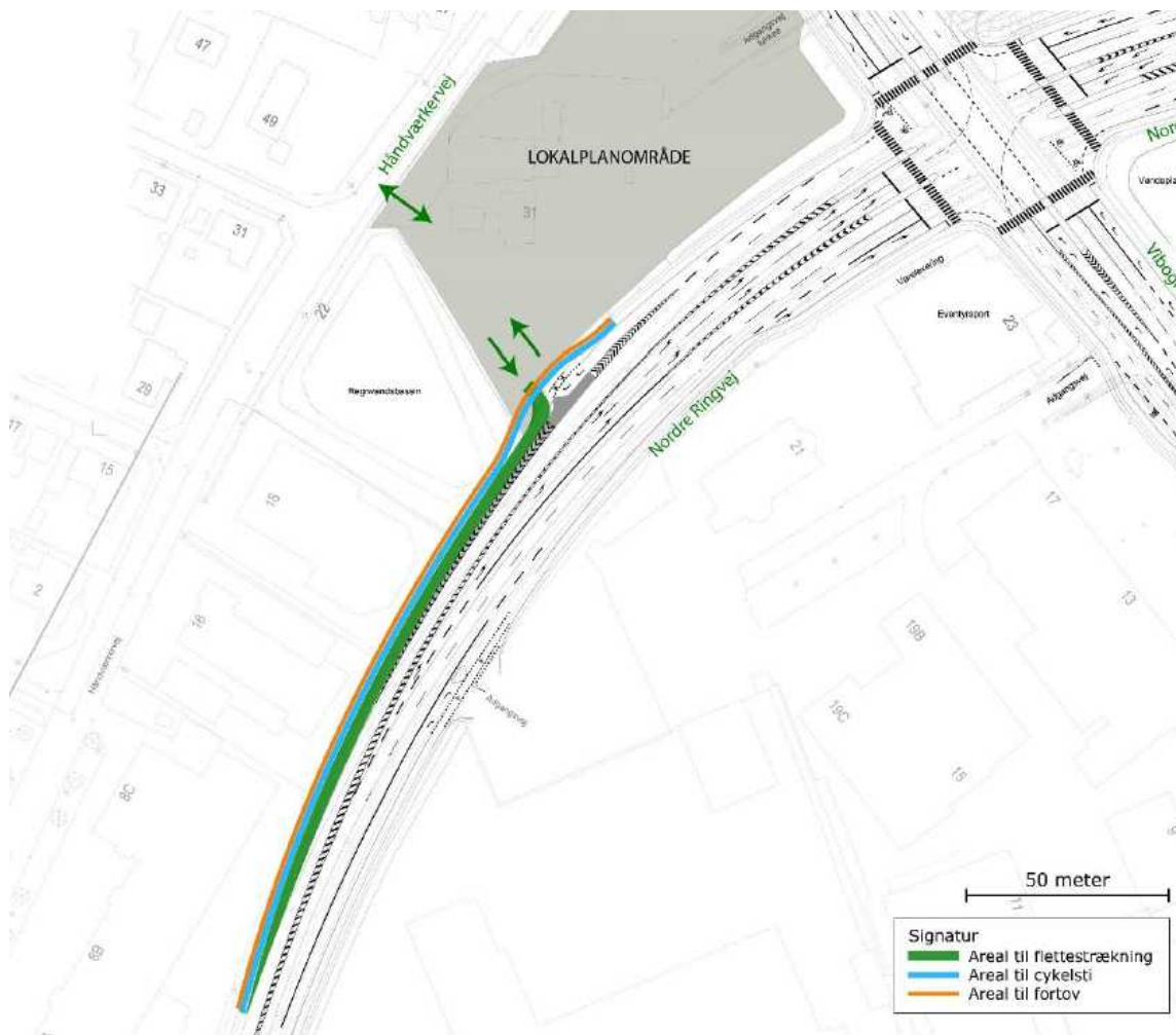
Figur 4: Udformning 3 med vejadgang fra Viborgvej 31 til Nordre Ringvej med flettestrækning mod sydvest, hvor trafikanterne kan indflettes på Nordre Ringvej.
